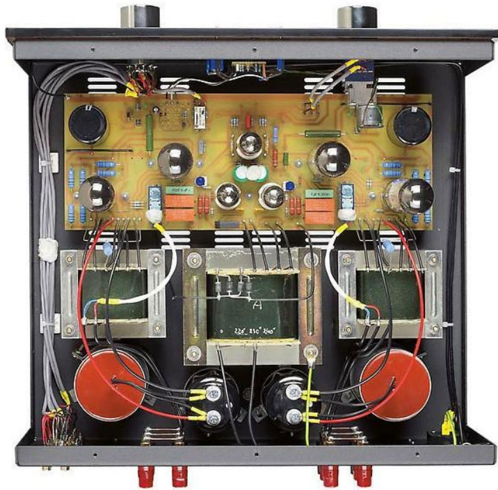
L' ARIA à cœur ouvert : 1 x ECC83S JJ Electronic pour l'étage d'entrée, 2 x ECC83S JJ Electronic pour l'étage Driver, et 4 x E34L JJ Electronic à polarisation automatique pour l'étage de sortie.
